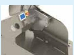
スライス歩留まりに貢献する当て板は着脱を制限。清掃時に外して清掃することがなくなり、不意な刃物への接触リスクを低減します。
