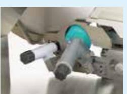
刃物研磨時、グラインダー装置の取り付けの有無を確認し、取り付けられていない状態での機械作動を防止します。
