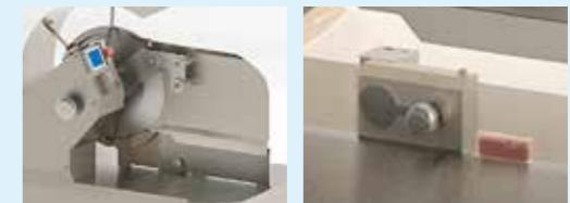
刃物下部に設置する刃物側板にはセーフティセンサを採用。信頼性の高いセンサにより不意な機械作動を防止します。
